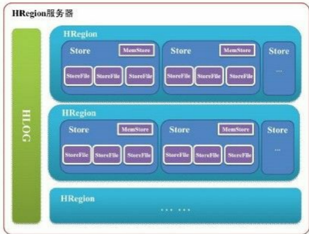
图 12-9 HRegion服务器体系结构
